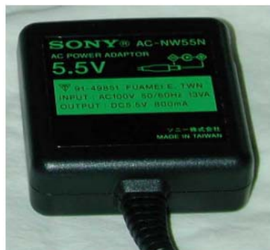
図1-AC-DC電源装置の銘板出力電圧および電流の例
