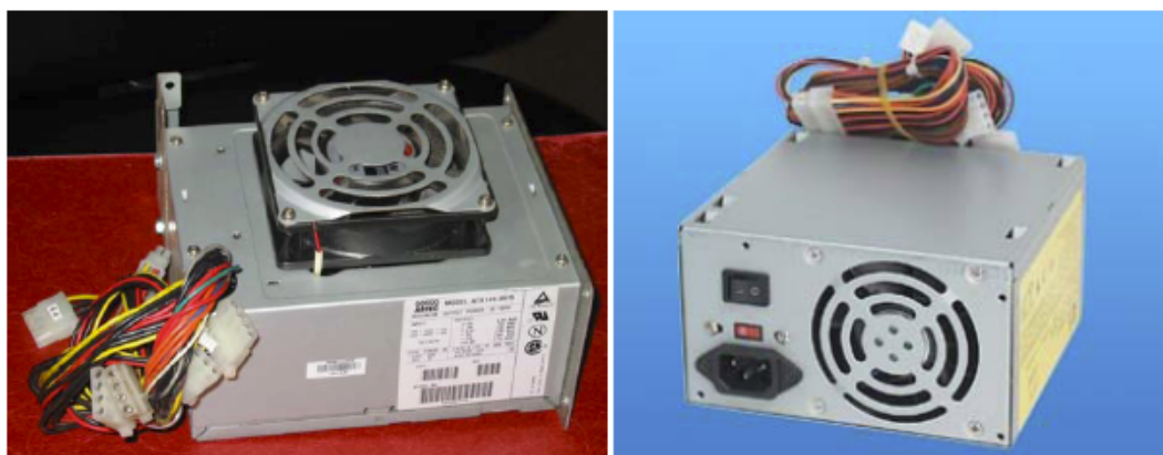
(a) 閉鎖型構造の内部電源装置
